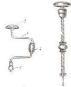
Fig. 2.26. Coarbe a - coarbă; b - dispozitiv de fixare a burghiilor cu diametre mici; 1 - tijă metalică; 2 - manșon prismatic; 3 - manșon ciupercă; 4 - manșon din lemn
